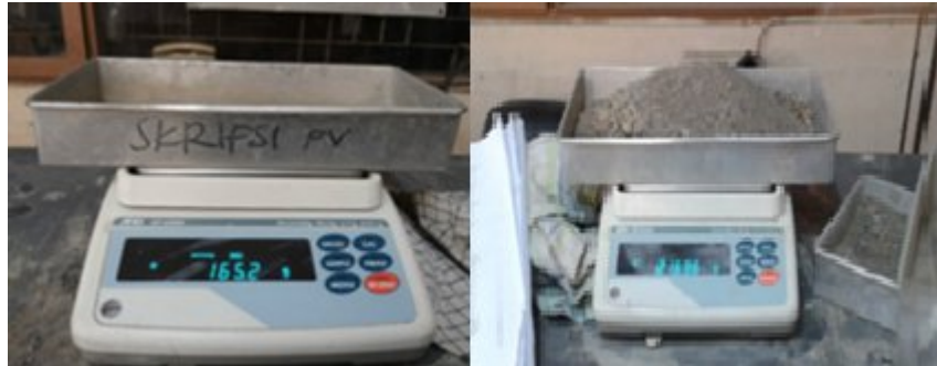
Gambar 2.5 Berat loyang (1) dan Berat loyang dan material (2) (Sumber : Erwinyui, 2013”pengujian analisis Saringan Agregat Halus”)
