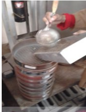
Gambar 2.7 Pengisian sampel pasir ke saringan (Sumber : Erwinyui, 2013”pengujian analisis Saringan Agregat Halus”)
